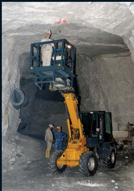
Оборщик PAUS RL 852 TSL уже успел отлично зарекомендовать себя в шахтах Чили и Республики Беларусь. Одной из типовых задач, решаемых этой машиной на медных рудниках Чили, является обделка кровли непосредственно после буровзрывных работ. Для обделки кровли фирма PAUS рекомендует гидроударник НРК (модель 203).
