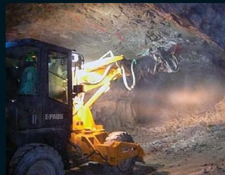
Отличная маневренность и небольшие габариты машины позволяют легко добраться до самых труднодоступных областей. Оператору требуется всего несколько секунд для установки рабочей площадки вместо гидромолота. При этом не требуется дополнительного обслуживающего персонала. Благодаря этому кровля может быть быстро закреплена и процесс проходки продолжен, а в это время машина переезжает для работы в новой выработке.
