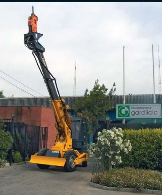
Новая конструкция машины предусматривает шарнирное рулевое управление ( $\pm 45^\circ$ ), наличие телескопической стрелы и поворотного механизма стрелы ( $\pm 90^\circ$ ). Уникальное сочетание этих конструктивных особенностей обеспечивает прекрасную маневренность оборщика кровли как во время работы, так и при перемещении по выработкам шахты.
